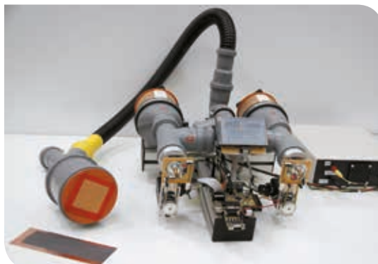
Kraftgeregelter Niederdruckflächengreifer zur Handhabung keramischer Grünfolien
