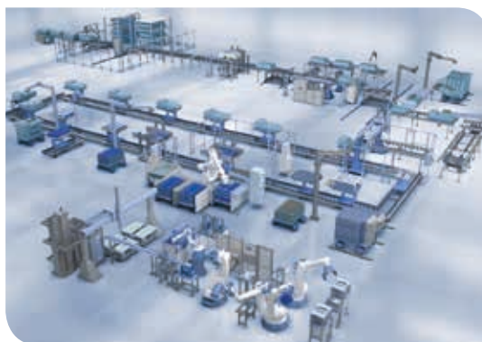
Layout einer Batteriemontage (Dürr)
