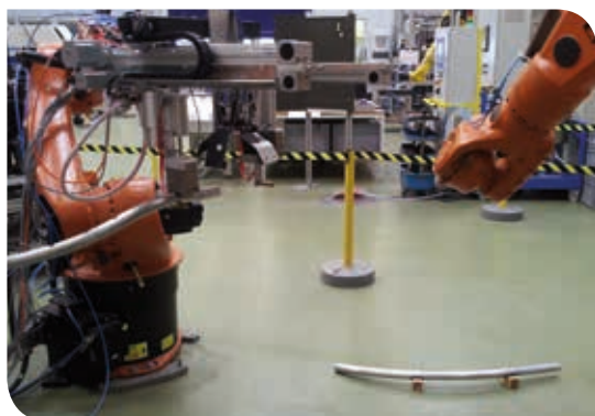
Vorrichtungsfreie Anordnung von Fügepartnern in der Montagezelle
