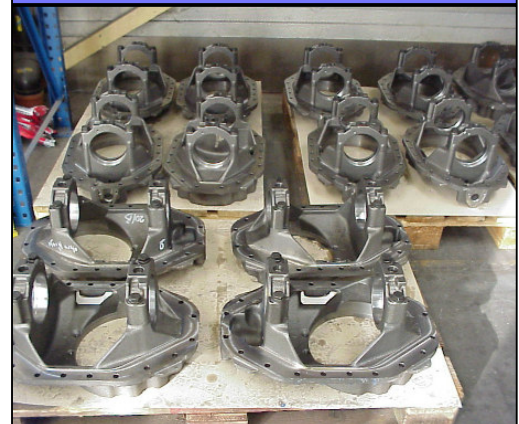
Pro Jahr sollen mit der Anlage etwas über 55.000 Gehäuse aus GGG 40 im Dreischichtbetrieb gefertigt werden
