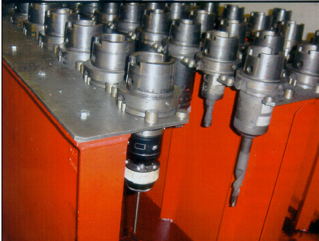
Die hängende Anordnung der Werkzeuge in den Magazin-Kassetten (der DIN-Kegel liegt oben) verhindert eine Verschmutzung des Werkzeugkegels durch ablaufendes Restkühlmittel und Späne
