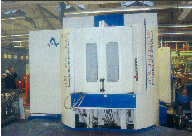
Bei der nhb 170 bildet das einteilige Maschinenbett in Gusskonstruktion eine starre Basis für die Maschinenaufbauten
