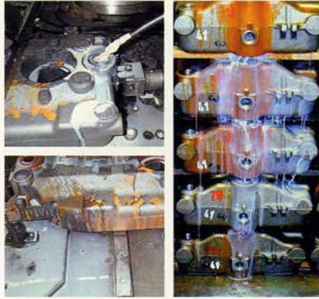
Bild 3 Trockene Bauteile, eine saubere Maschine und damit eine größere Arbeitsplatzqualität sind das Ergebnis der Umstellung von der Überflutungskühlung mit Kühlschmierstoff auf eine Minimalmengen Kühlung.
