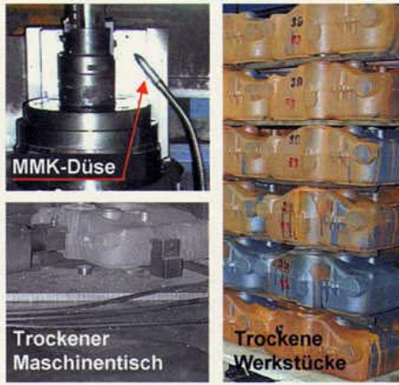
Bild 3 Trockene Bauteile, eine saubere Maschine und damit eine größere Arbeitsplatzqualität sind das Ergebnis der Umstellung von der Überflutungskühlung mit Kühlschmierstoff auf eine Minimalmengen Kühlung.
