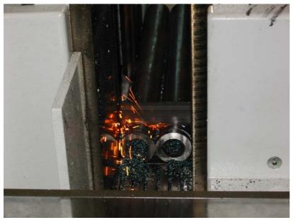
Ein auf 62 HRc gehärteter Stahl wird in Lage gesägt.
